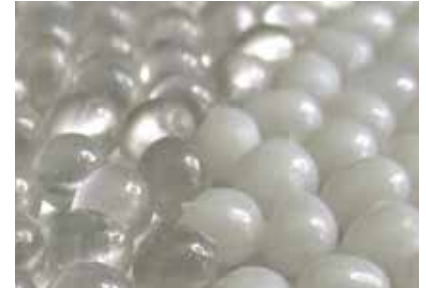
Anwendungsbeispiel PET: links amorphes Granulat, rechts teilkristallines Granulat – Kristallisationsgrad von 30-40 % Bild: ECON GmbH
