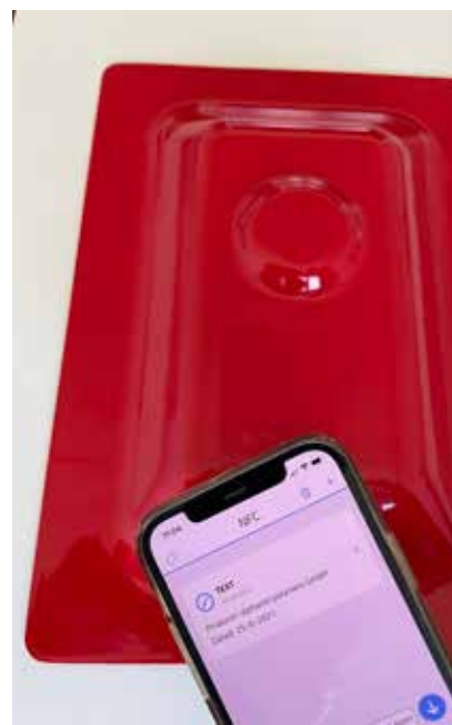
Einfach das Smartphone an den Bauteil ranhalten und schon wird die NFC-Verbindung hergestellt. Wichtige Informationen werden dann übersichtlich angezeigt. Bild: alpharim polymers GmbH
