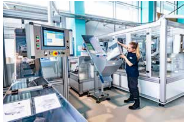
Befüllung des Schüttgut-Bunkers in der vollautomatisierten Fertigungsanlage Bild: Hagleitner/Krug
