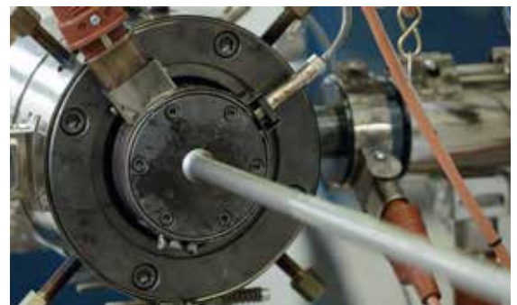
Extruderkopf einer Produktionslinie Bild: KE KELIT
