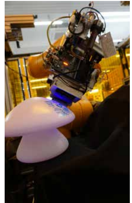
Die RoboInkjet-Druckanlage bedruckt konformal ein 3D-Spritzgussteil. Bild: PROFACTOR GmbH
