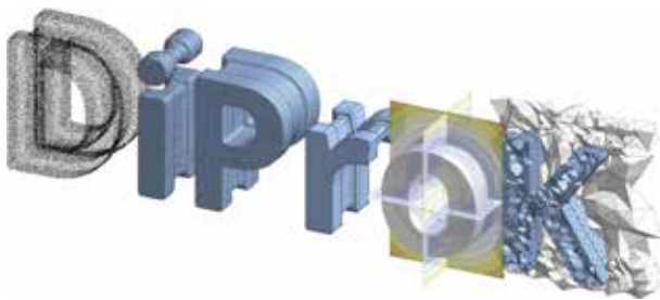
DiProK steht für: D (Punktwolke), i (Polygonnetz: 2D-Oberfläche gebildet durch ein Netz von Dreiecken), P (Polygonnetz: 2D-Oberfläche gebildet durch ein Netz von Vierecken), r (Begrenzungsflächenmodell: 2D-Oberfläche gebildet durch nichtlineare Regel- und Freiformflächen), o (Implizite Fläche) und K (3D-Volumenmodell, dargestellt durch Tetraeder) Bild: DiProK
