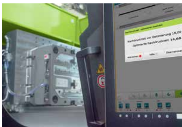
Oft liegt die optimale Nachdruckzeit niedriger als die zu Beginn eingestellte. Dadurch verringert sich die Zykluszeit. Bild: ENGEL
