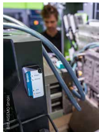
Der kompakte Bluetooth-Sensor, der die Maschinen-daten für AISEMO Analytics erfasst, muss lediglich auf die bewegliche Seite der Schließeinheit einer Spritzgießmaschine geklebt werden.
