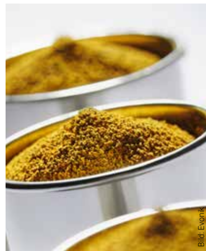
Das P84® Polyimidpulver vereint einzigartige Eigenschaften: temperaturbeständig bis 350 °C, hohe mechanische Festigkeit, niedrige Reibwerte, minimaler Abrieb.
