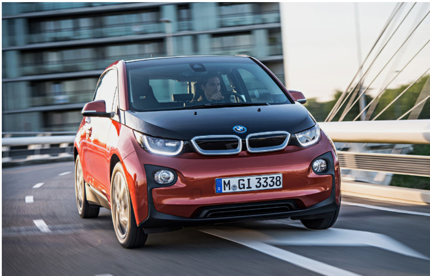
Ein werkstoffübergreifender Materialmix als aktueller Ansatz des modernen Leichtbaus: Der BMWi3 ein Großserienfahrzeug, dessen Fahrgastzelle aus kohlefaserverstärktem Kunststoff und dessen Fahrgestell aus einer Aluminiumlegierung besteht. © Copyright BMW AG, München (Deutschland)
