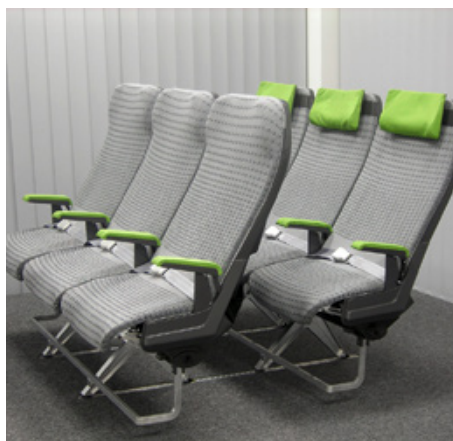
In Zusammenarbeit mit der Firma Greiner PURtec entwickelte HDEMC einen neuartigen Flugzeugsitz für den Passagierbereich. Dabei wurde ein technisches Gestricke als Sitzoberfläche eingesetzt. Bild: HDEMC
