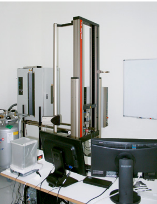
Prüfmaschine zur Ermittlung der mechanischen Eigenschaften von Polymeren bei -80^{\circ}\text{C} bis 250^{\circ}\text{C} . Bild: tortuetec
