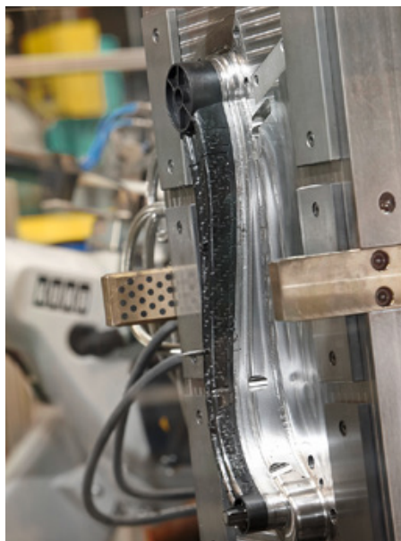
Das neue Langfaser-Direktspritzgießen demonstriert Arburg mit dem Umspritzen von zwei endlosfaserverstärkten Thermoplasteinlegern (Tepex-Organoblech). In 40 s wird ein über 500 mm langer und nur 200 g schwerer hochfester Composite-Hebel gefertigt. Bild: Arburg
