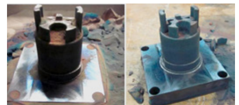
Abb. 2: Einsätze für Spritzgießwerkzeuge aus 1.2344 (links) und HTCS-150 (rechts). Bild: FH Wels
