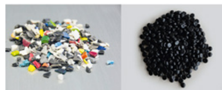
Das Resultat der neuen INTAREMA® RegrindPro® Recycling-technologie für Mahlgüter ist eine maximale Granulatqualität für maximalen Rezyklatanteil im neuen Endprodukt. Bild: EREMA
