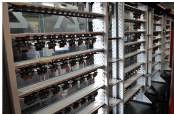
Werkstück- und Elektrodenmagazin der Erodieranlage. Bild: Glatzer
