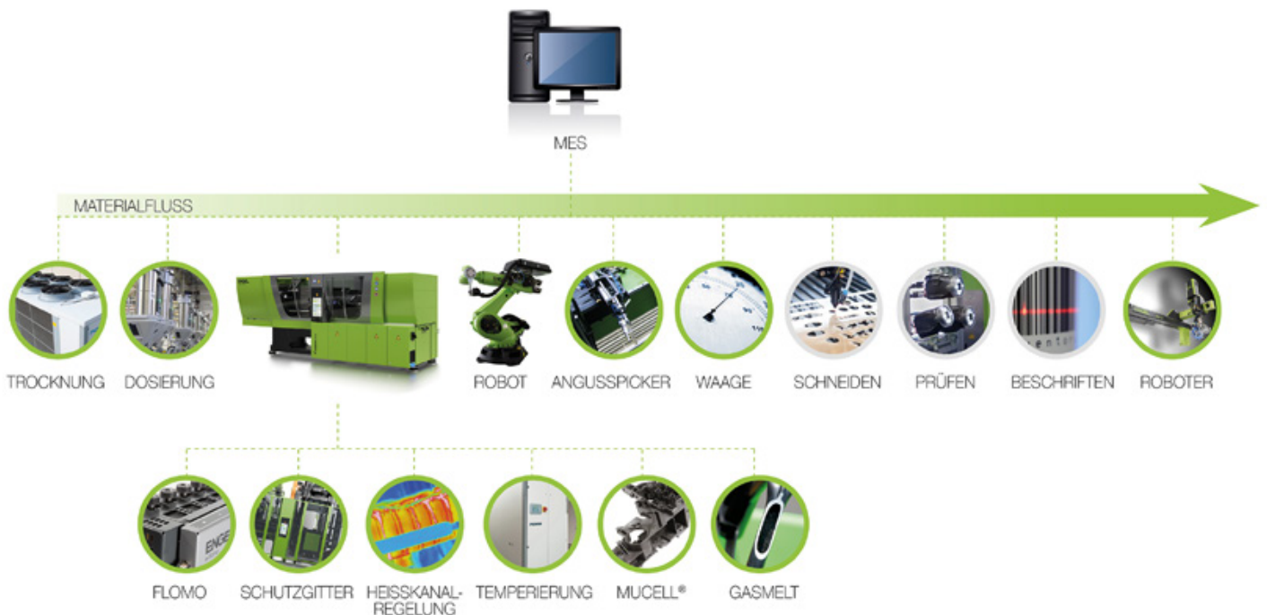
Horizontale und vertikale Datenintegration in einem Spritzgießbetrieb. Bild: ENGEL
