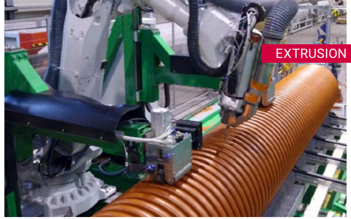
Bearbeitungszentrum von Bauernfeind: Fräsarbeiten mit Hilfe eines CNC-gesteuerten 6-Achs-Roboters mit einem Stabfräser. Bild: Bauernfeind
